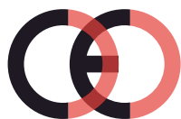
Virheellinen CE-merkki (liian lähellä)
