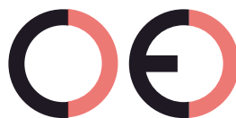
Virheellinen CE-merkki (liian kaukana)
